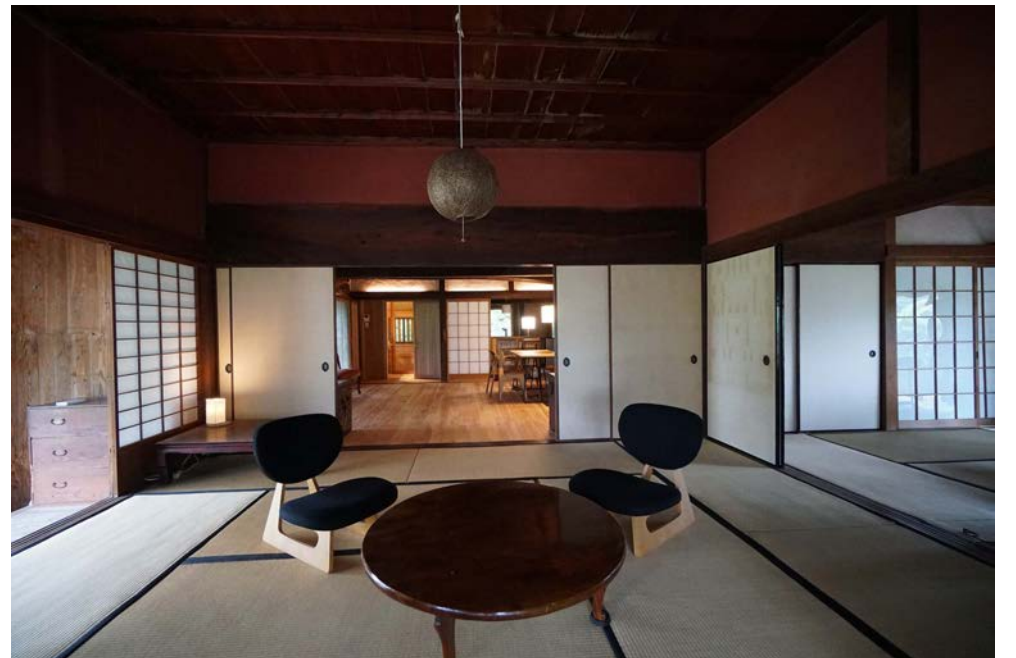
ゲンカンノマは保存部分 左側玄関は新材の天井を解体し旧態の天井を現し利用
