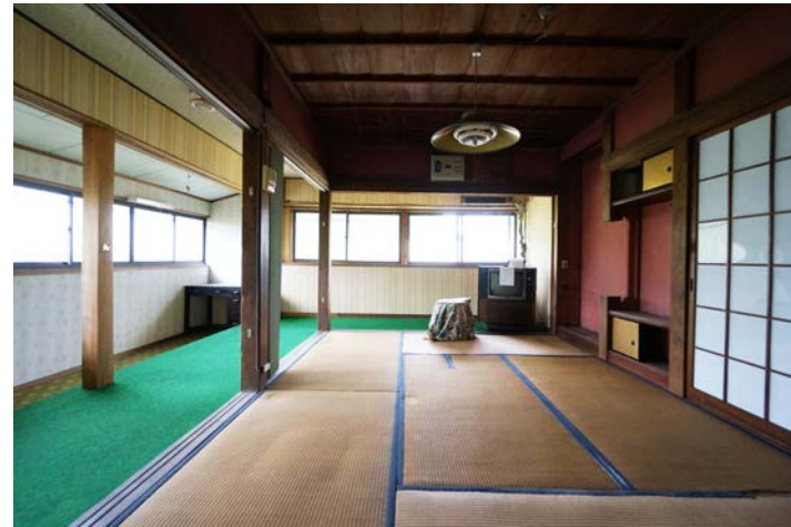
改修前のコザ 腰窓に改変され右側に約 90cm 増築されていた
