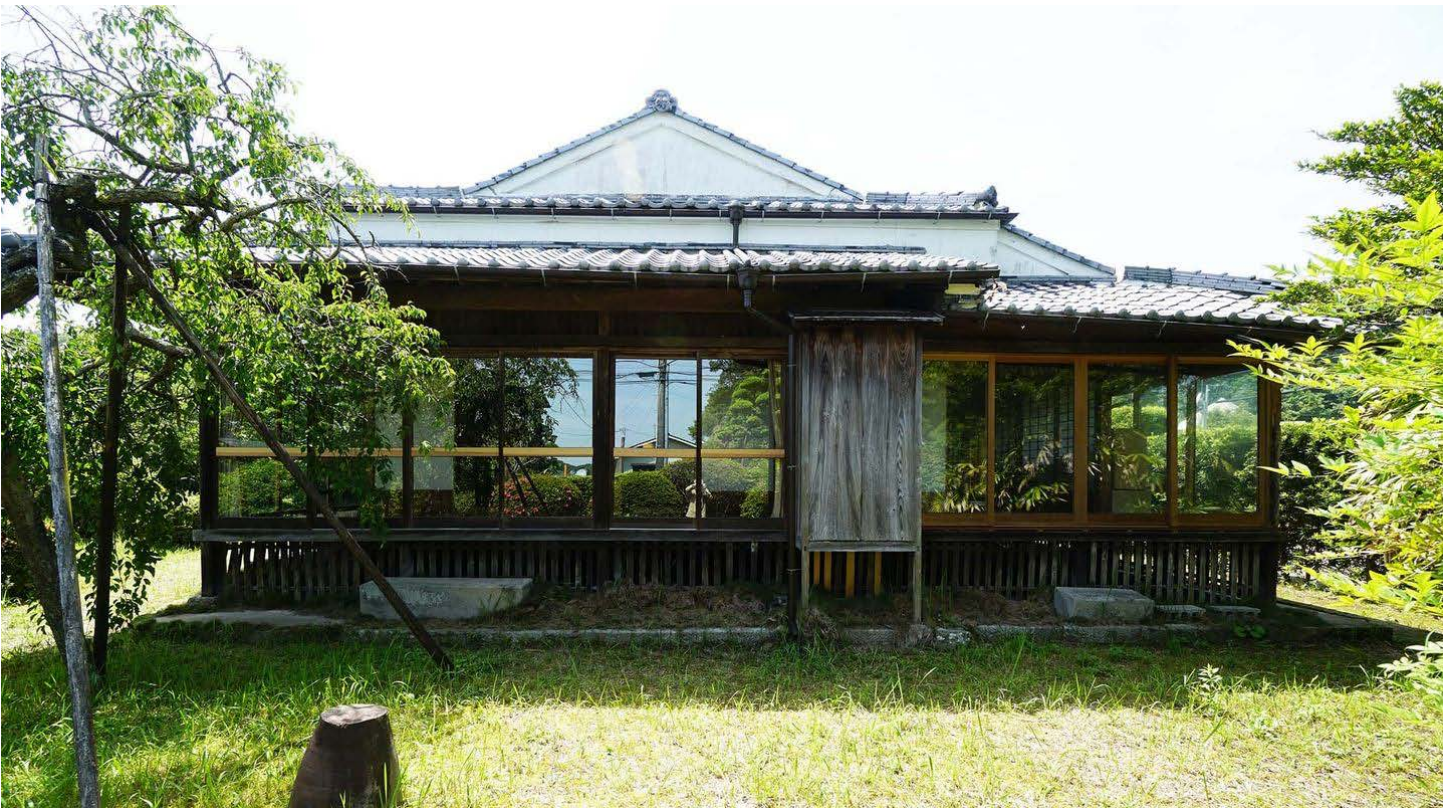
修復再生後の東側外観 中央の戸袋に左右の雨戸が残されており、北（右）側の腰窓を掃き出し窓に修復した
